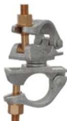
A **abraçadeira giratória (SW)** é usada para conectar dois tubos em qualquer ângulo. É classificada como uma junta estrutural articulada. É usada para andaimes de estrutura, modulares, tubulares e acopladores para conectar dois tubos cujo diâmetro externo é de 48,3 mm em qualquer ângulo, ou seja, para anexar contraventamento diagonal adicional, treliças, estruturas de proteção contra chuva ou para estabilizar a estrutura do andaime com tubos.
