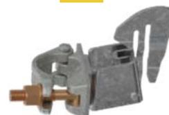
A **abraçadeira de guarda costas** também é um acoplador auxiliar, usado para fixar guarda costas adicionais em andaimes, principalmente quando a plataforma de trabalho é afastada da fachada em mais de 20 cm. É composta por metade de um engate giratório (possibilita a fixação de tubos com diâmetro externo de 48,3 mm) e um bolsão com cunha para montagem de guarda costas extra.
