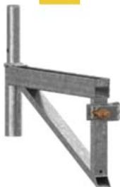
A consola 50 com pino é utilizado se for necessário encurtar ou alargar o vão do andaime em 0,5 m. Trata-se de uma estrutura composta por três perfis fechados, dotados de meio-engate e perno para fixar o marco do piso seguinte. A consola é montada na coluna com uma meia-abraçadeira, ao mesmo tempo que o suporta por um encaixe de extremidade de seção diagonal de formato especial.
