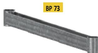
A travessa inicial de aço é aplicada em duas bases reguláveis e pode ser utilizada para a montagem de plataformas ou da viga inferior da escada no nível 0. É composta por dois tubos conectados por um perfil em U para montagem em plataformas, com 320 mm ou 605 mm de largura.
