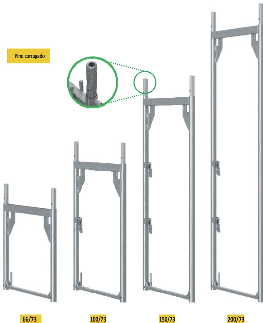
Os Marcos em alumínio vêm num sistema de largura (732 m) e quatro alturas, onde a estrutura de 2,0 m de altura é a estrutura padrão e as outras são usadas principalmente no nível inferior do andaime para nivelamento em terrenos irregulares ou um ajuste mais preciso com a estrutura do prédio.
