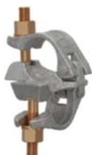
A **abraçadeira ortogonal (RA)** é usada para unir dois tubos em ângulo reto. É classificada como junta estrutural fixa ou normal. É utilizada em andaimes de armação, modulares, tubulares e acopladores para conectar dois tubos cujo diâmetro externo é de 48,3 mm no ângulo de 90°, em particular para braços de amarração ao marco, vigas treliçadas à estrutura do andaime e principalmente para unir os respectivos componentes de andaimes a estruturas.
