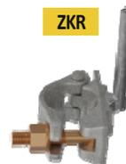
A **abraçadeira de rodapé** é um componente auxiliar utilizado para a montagem de rodapés extras em andaimes, principalmente quando a plataforma de trabalho está afastada da fachada mais de 20 cm. É composta por metade do meia-abraçadeira (possibilita a fixação de tubos com diâmetro externo de 48,3 mm) e um pino para fixação de rodapé extra em decks.
