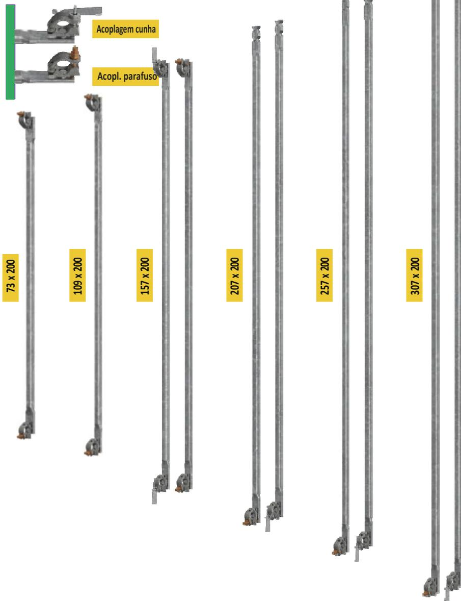
As **travessas diagonais** são feitas de tubos achatados em ambas as extremidades. Um deles (chanfrado) é moldado individualmente para cada sistema de largura de vão de 3,07 m a 2,07 m, e pé-direito padrão de 2,0 m. Na outra extremidade está um meio-acoplamento articulado com uma cunha ou parafuso, que é montado na extremidade do marco.
